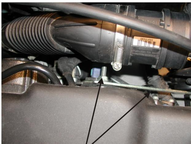
Montage de la patte de fixation pour le potentiomètre à l'aide de la vis d'origine. changer l'écrou d'origine par un écrou frein fourni dans le kit.)
