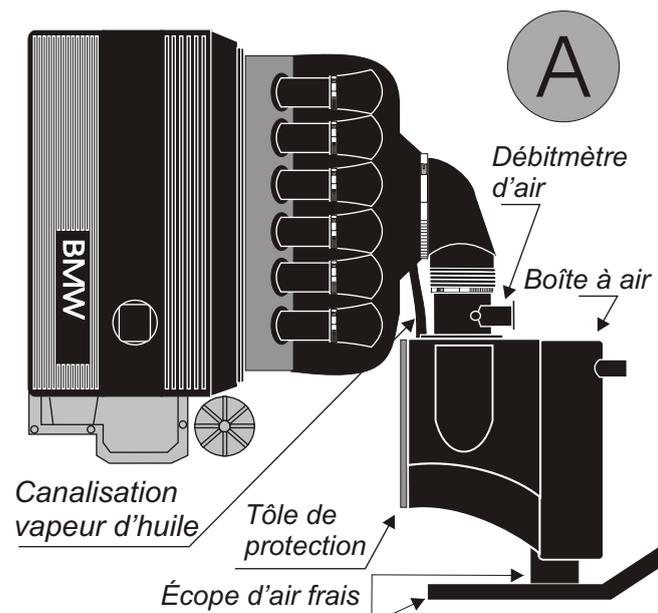
1) déposer le phare avant gauche afin de pouvoir déposer l'écoper d'air frais. (schéma A)
