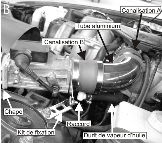
Emboîter la canalisation A du kit sur le boîtier papillon des gaz.(schéma B et C)
