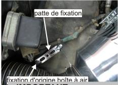
fixer le TWISTER à l'aide des pattes et des vis fournies sur la fixation d'origine de la boîte à air.
