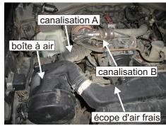
Déposer et supprimer la boîte à air complète ,la canalisation A/B ainsi que l'écope d'air frais.
