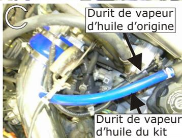
Emboîter la durit de vapeur d'huile du kit sur le tube aluminium puis sur le couvre culasse.(schéma C et D)
