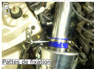
Positionner le tube aluminium sur la canalisation A du kit.(schéma D)
