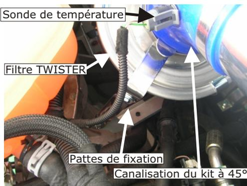
Emboîter le filtre à air TWISTER sur la gaine d'air frais. Positionner le filtre à air TWISTER sur le tube aluminium à l'aide de la canalisation du kit à 45°. Fixer le filtre à air TWISTER à l'aide des pattes de fixation sur le support de la boîte à air. Positionner la sonde de température sur la canalisation à 45°. Positionner le filtre à air TWISTER afin qu'il ne touche aucun organe mécanique.
