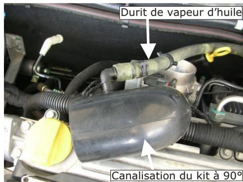
Positionner la durit de vapeur d'huile sur le raccord de la canalisation du kit à 90°.
