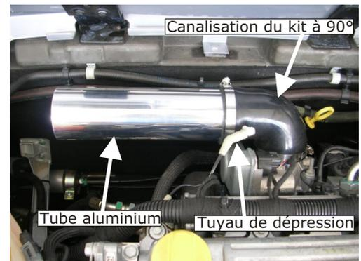
Emboîter la canalisation du kit à 90° sur le boîtier papillon des gaz. Positionner le tuyau de dépression sur le raccord de la canalisation du kit à 90°. Emboîter le tube aluminium sur la canalisation du kit à 90°.
