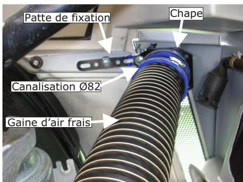
Positionner la chape du kit derrière l'écope d'air latérale gauche puis la fixer à l'aide de la patte de fixation fournie sur l'aile à l'aide de la vis d'origine. Emboîter la gaine d'air frais sur la chape à l'aide de la canalisation du kit Ø82.
