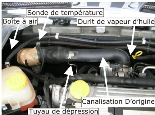
Déposer et supprimer la boîte à air d'origine ainsi que la canalisation d'origine. Désaccoupler la sonde de température ainsi que le tuyau de dépression et la durit de vapeur d'huile de la canalisation d'origine.
