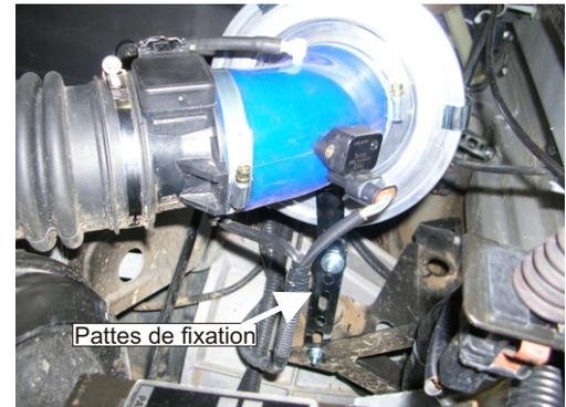
Fixer le filtre à air TWISTER à l'aide des pattes de fixation fournies sur le support de la boîte à air.
