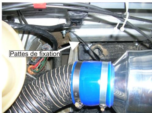
Fixer le filtre à air TWISTER à l'aide des pattes de fixation fournies sur le tablier avant..
