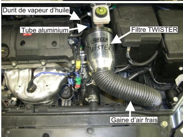
Emboîter le filtre à air TWISTER sur le tube aluminium.
