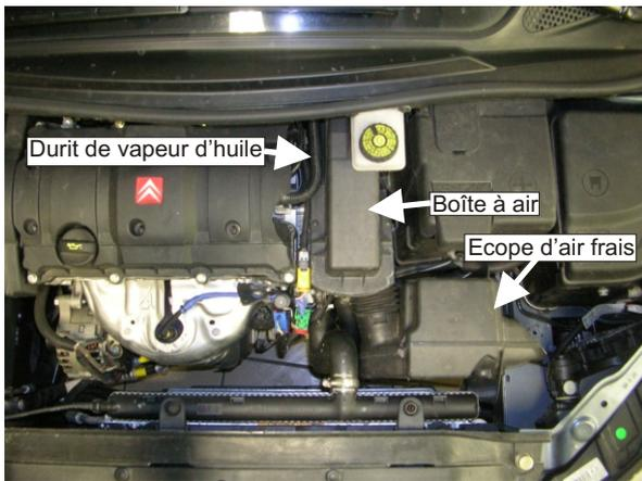
Déposer et supprimer la boîte à air d'origine ainsi que l'écope d'air frais.
