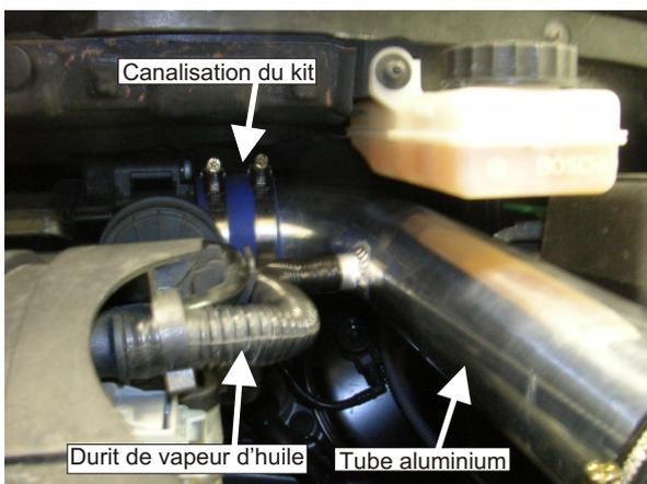
Positionner la canalisation du kit sur le boîtier papillon des gaz.
