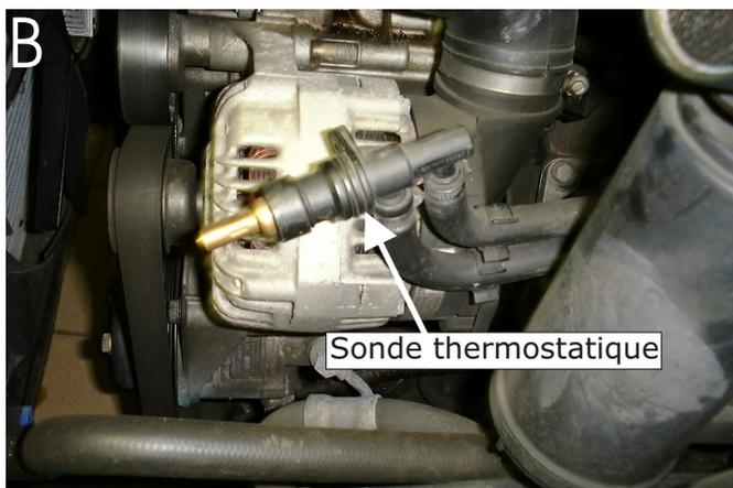
Positionner la sonde thermostatique sur le tube aluminium.(schéma B et C)
